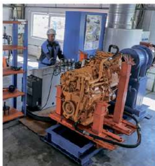
Испытания и обкатка гидромеханической передачи после ремонта
