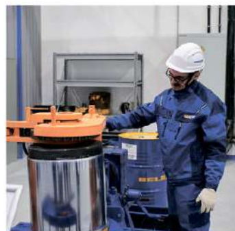
Ремонт цилиндра подвески
