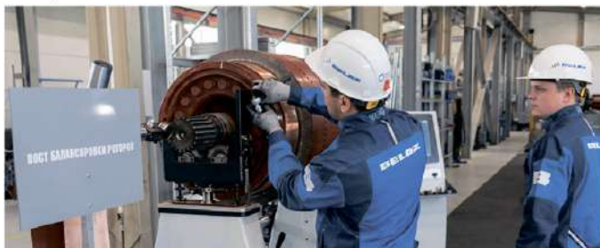
Балансировка ротора электрических машин после ремонта
