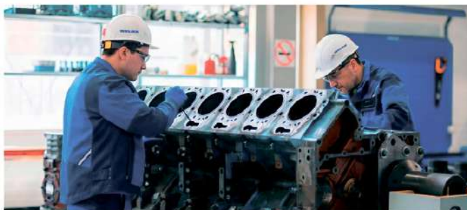
Процесс ремонта ДВС ГЗПД на манипуляторе-кантователе
