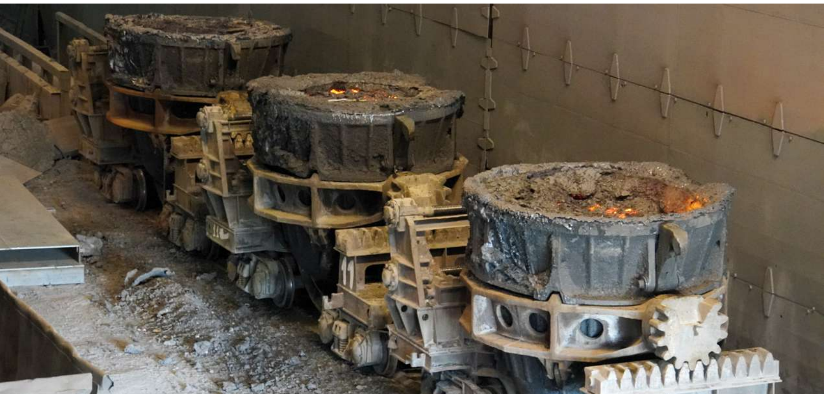
Шлаковозы на металлургическом производстве
