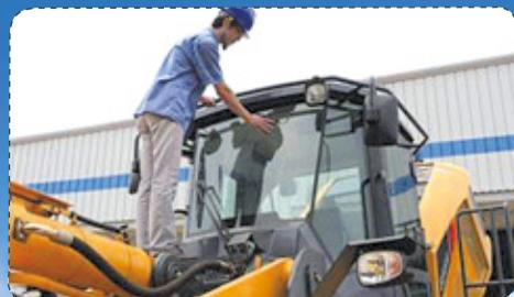
Современная кабина с круговым обзором 309° имеет большое пространство, улучшенное поглощение шума и оснащена по всему периметру крыши специальным поручнем для безопасности обслуживающего персонала.
