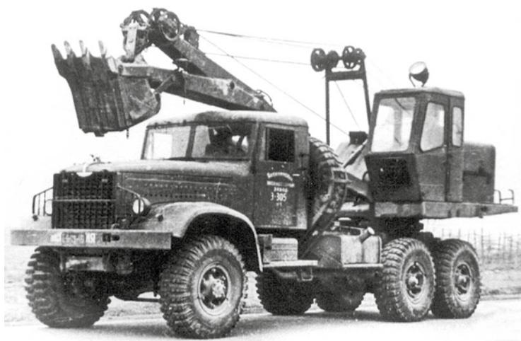
*Э-305 на шасси грузовика ЯАЗ-214 долгое время использовали военные*
