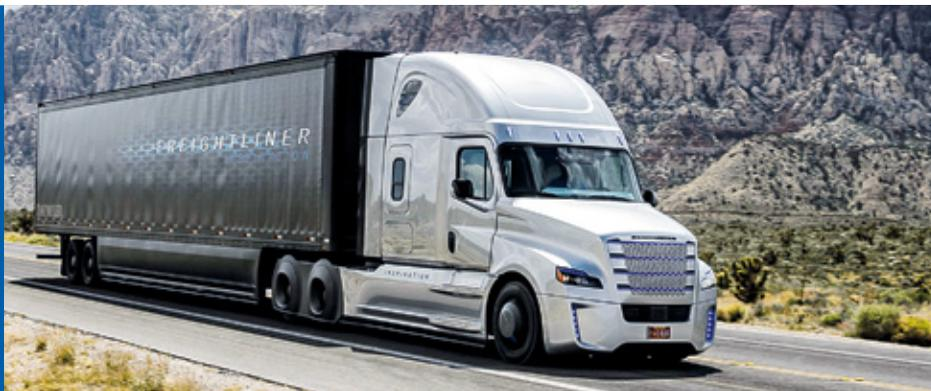
Облегчить жизнь дальнбойщикам призвана новая система Highway Pilot, разработанная специалистами Daimler Trucks. Пока она установлена только в модель Inspiration Truck, созданную на базе Freightliner Cascadia. Это своеобразный автопилот, контролирующей окружающую среду с помощью фронтальных радаров и панорамной камеры, которые фиксируют
