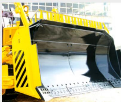
«Установка открылков — один из самых распространенных способов увеличения производительности бульдозера — позволяет увеличить объем перемещаемого грунта и снизить потери. Мы бы рекомендовали шарнирную установку открылков, поскольку это позволит работать на разных типах грунта, а также обеспечит легкий демонтаж.
