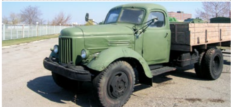
В ЗИЛ-164 применялся двигатель мощностью 97 л. с.
