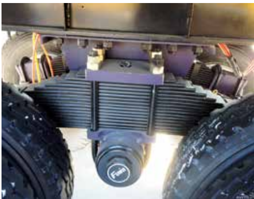
Балансирная подвеска применяется на трех- и более осных шасси
