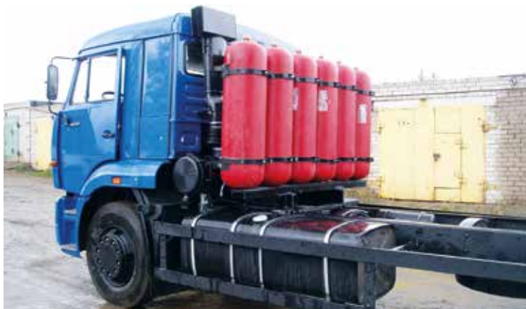
Газовые баллоны закрепляют за кабиной...
