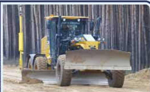
MOBA GS-506 3D GNSS – универсальная система, подходящая для крупных проектов
