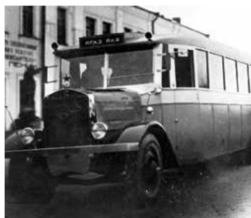
120-сильный мотор разгонял ЯА-2 до 51 км/ч
